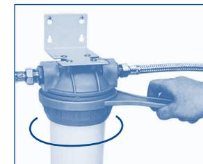
Уплотнительное резиновое кольцо в канавку корпуса (при повреждении кольца заменить его на новое). Навернуть гайку с корпусом на крышку до упора. Подать воду в водоочиститель и проверить герметичность соединения корпуса и крышки, после чего водоочиститель готов к повседневному использованию.
